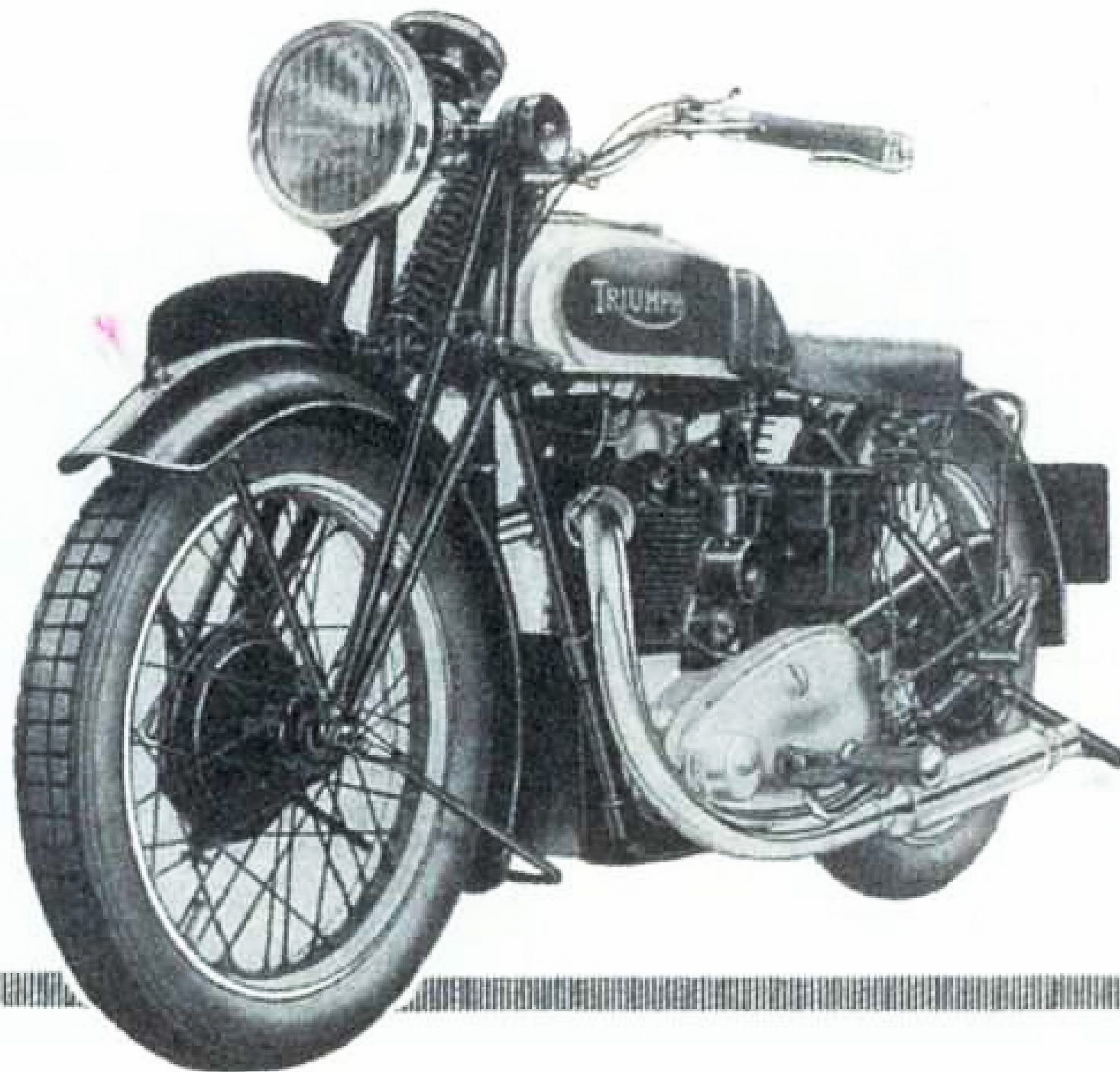
MODELLO 2/5 (250 c.c.) CON IMPIANTO LUCAS 6 V. CRUSCOTTO AL SERBATOIO (FARO TUTTO CROMATO EXTRA)
